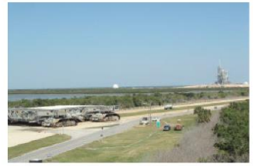
ロケット全体を打ち上げ場所まで立てたまま輸送する車両(ケープケネディ宇宙センター)
